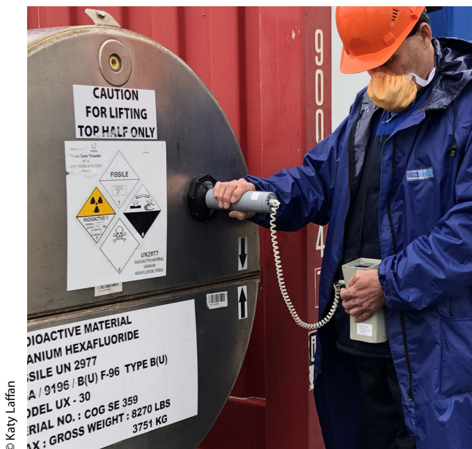
Измерение потока радиации из контейнера с ядерным материалом.
